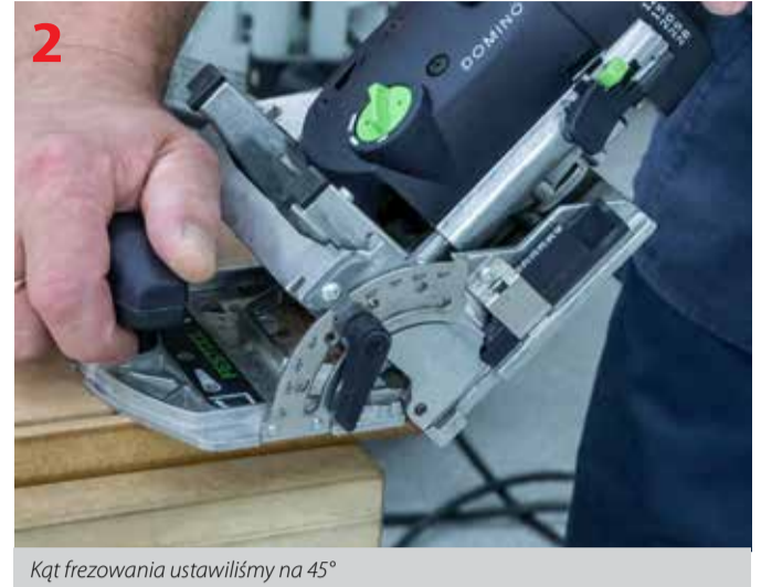
Kąt frezowania ustawiliśmy na 45°
