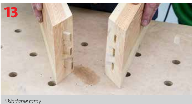
Mocowanie łączników Domino w elementach ramy sosnowej
