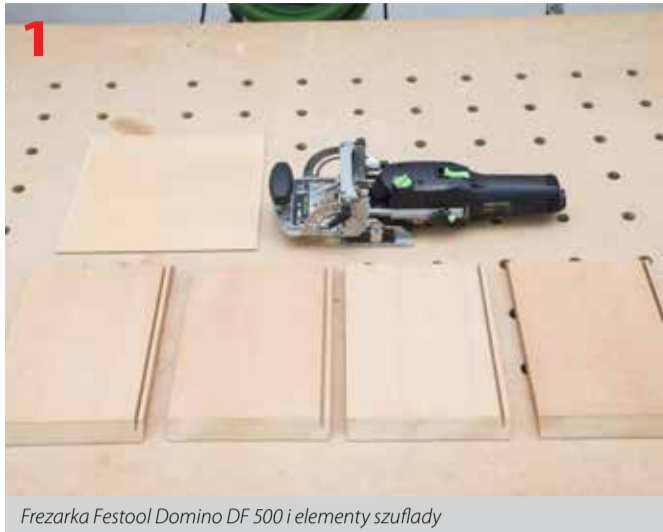
Frezarka Festool Domino DF 500 i elementy szuflady
