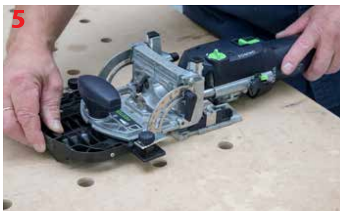
Montaż prowadnicy do elementów okrągłych w stoliku frezarki Festool Domino DF 500
