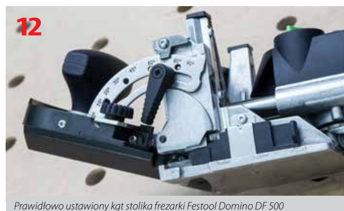
Prawidłowo ustawiony kąt stolika frezarki Festool Domino DF 500
