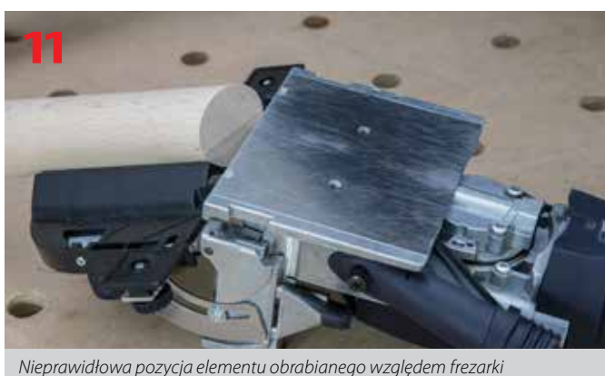
Nieprawidłowa pozycja elementu obrabianego względem frezarki
