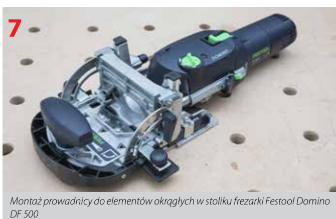
Prowadnica do elementów okrągłych umożliwia dokładne ich pozycjonowanie
