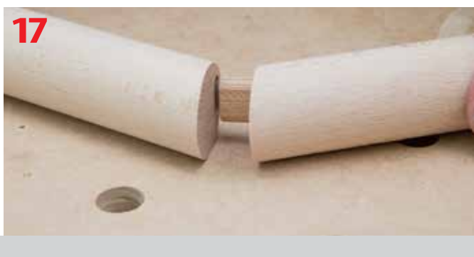
Prawidłowo wykonane gniazda w łączonych elementach poręczy zaciętych pod kątem 22,5°
