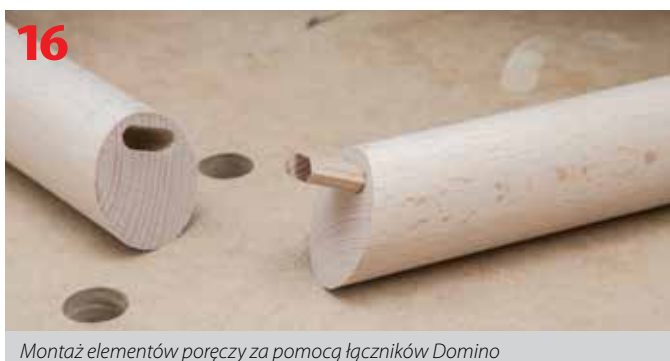
Frezowanie łączonych elementów poręczy zaciętych pod kątem 22,5°
