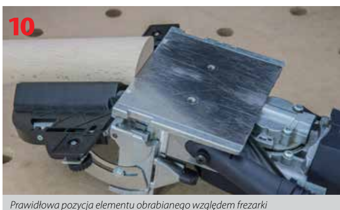
Prawidłowa pozycja elementu obrabianego względem frezarki
