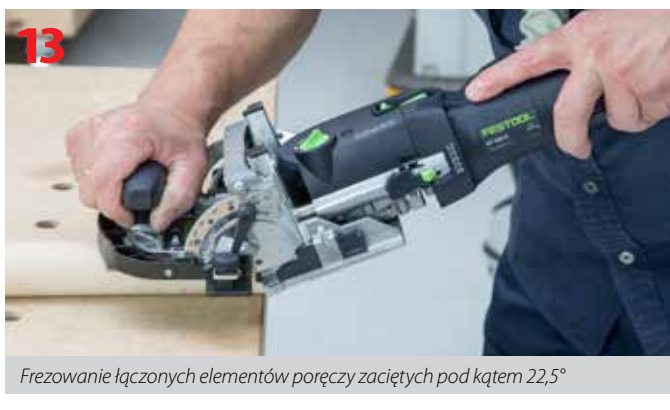
Prawidłowa pozycja elementu obrabianego względem frezarki
