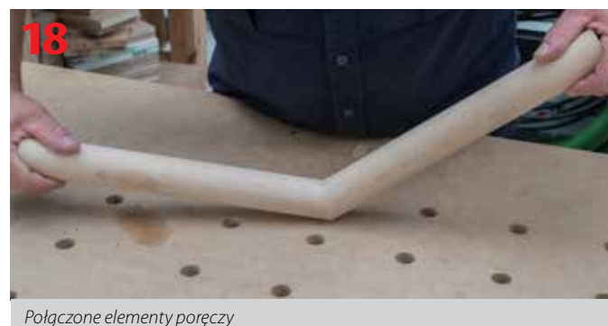
Montaż elementów poręczy za pomocą łączników Domino
