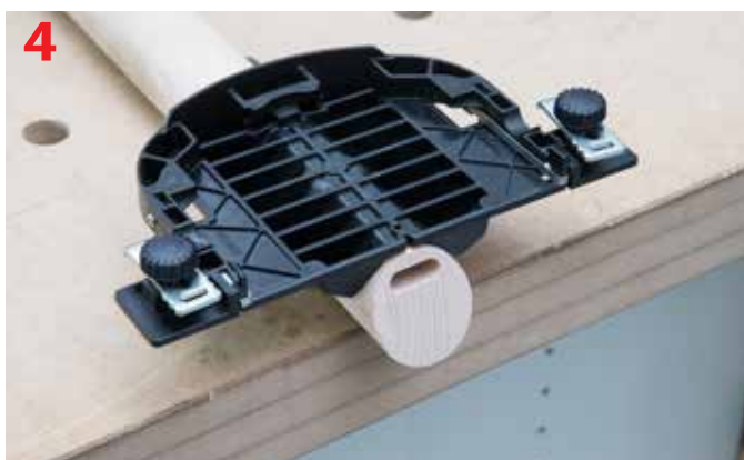
Prowadnica do elementów okrągłych umożliwia dokładne ich pozycjonowanie
