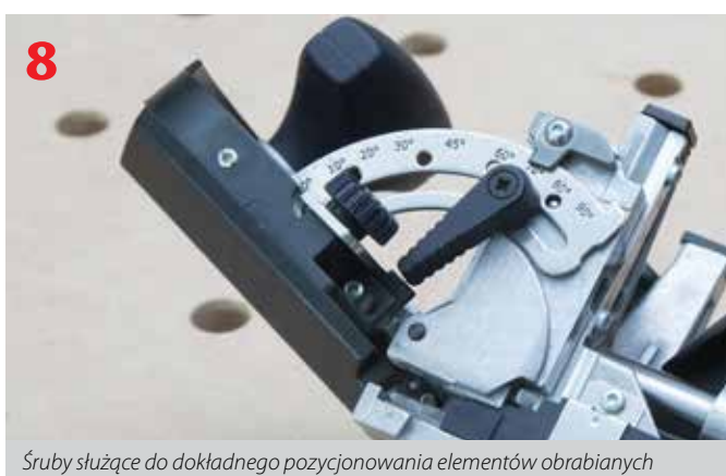
Montaż prowadnicy do elementów okrągłych w stoliku frezarki Festool Domino DF 500
