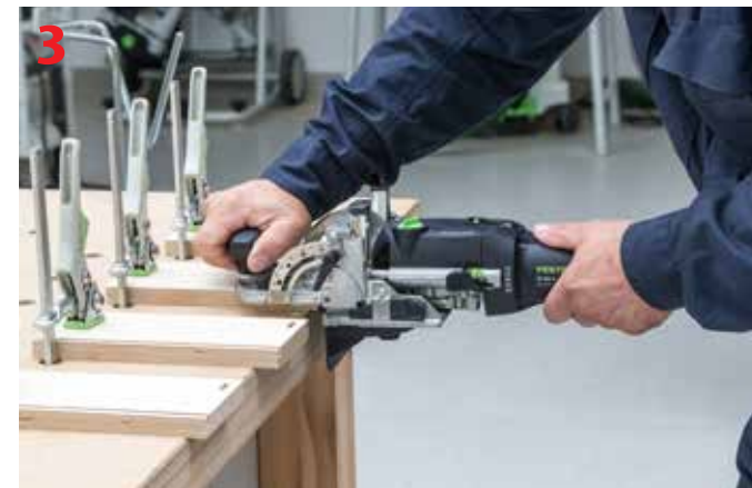
Frezarka Festool Domino DF 500 Q z podparciem kątowym, łączniki Domino 5 x 19 x 30 mm i ścisiki dźwigniowe Festool FS-HZ 160
