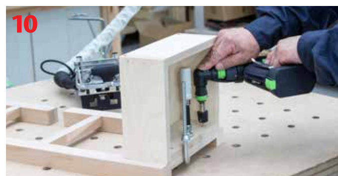
Montaż skrzynki do łączyny z nogami
