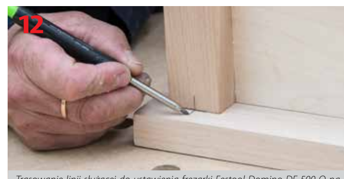
Trasowanie linii służącej do ustawienia frezarki Festool Domino DF 500 Q na montowanych elementach stołka
