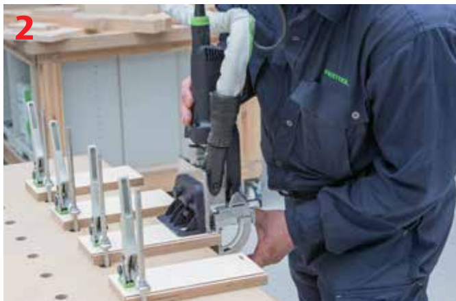
Frezowanie gniazd w bokach skrzynki
