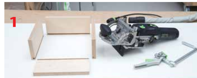
Frezarka Festool Domino DF 500 Q z podparciem kątowym, łączniki Domino 5 x 19 x 30 mm i ścisiki dźwigniowe Festool FS-HZ 160
