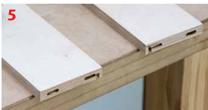
Frezowanie gniazd w bokach skrzynki
